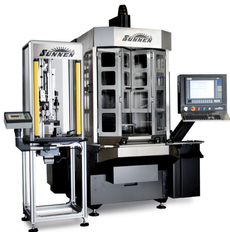
SUNNEN SV2010 mit externem Luftmess-System und Prozess-Feedback.
