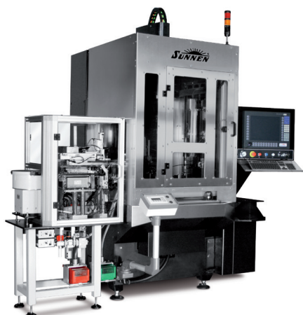
SUNNEN SV2015 mit linearer Lade- / Entlade-Einheit, Teilerüttler-Ladeeinheit, Indextisch innerhalb der Maschine für Mehrfach-Operationen wie Luftmessung mit 100% Feedback an die Spindel, Honen und Bürsten.
